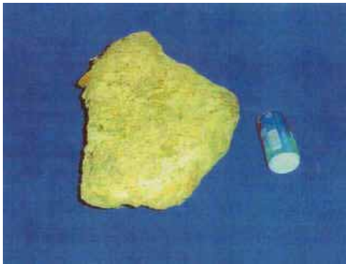
写真 1-1 オイルボール (出典 東京都環境局)
