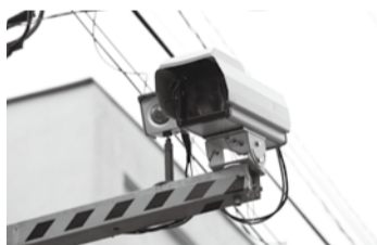
▲実証実験中の水害監視カメラ
