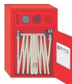
屋内消火栓設備
