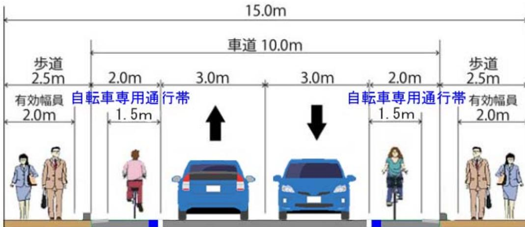
幅員 15 m の道路に自転車専用通行帯を設置する構成例
