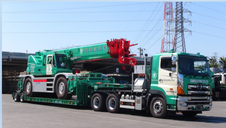
ラフタークレーン+トレーラ
