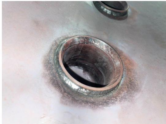
拡管部補修後（再拡管及びシール溶接）
