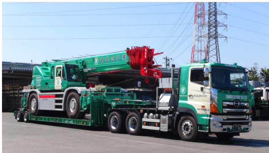
ラフタークレーン+トレーラ
