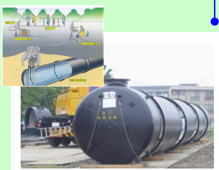
耐震性飲料用貯水槽水道管直結方式 100ト 1人1日3リットル1万人3日分
