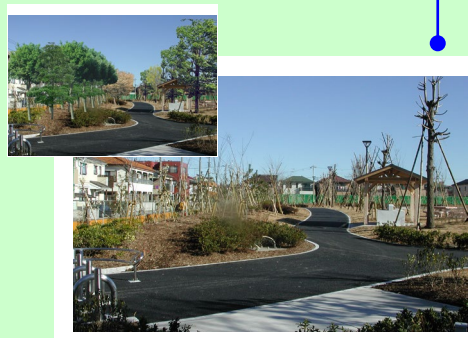
防火樹林帯 耐火性の強い常緑広葉樹主体で構成し、輻射熱を軽減します。
