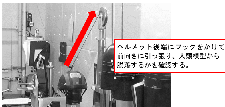
写真3. 保持装置の性能試験の様子
