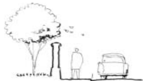
車を後退して歩道をつくる
