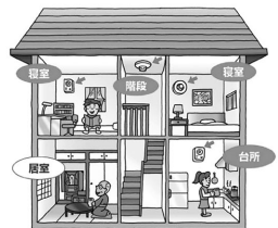
※住宅用火災警報器は、寝室、寝室のある階の階段、台所に設置が必要です。
