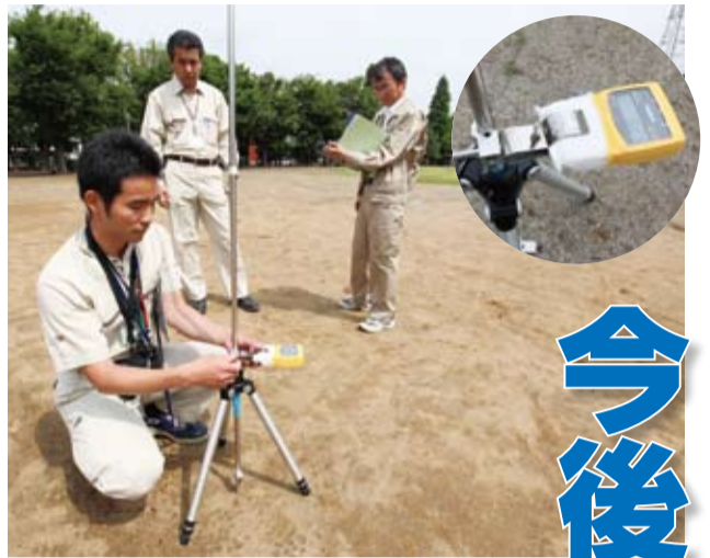
▲簡易式の測定器(右上)により駅前公園で大気中の放射線量を測定
