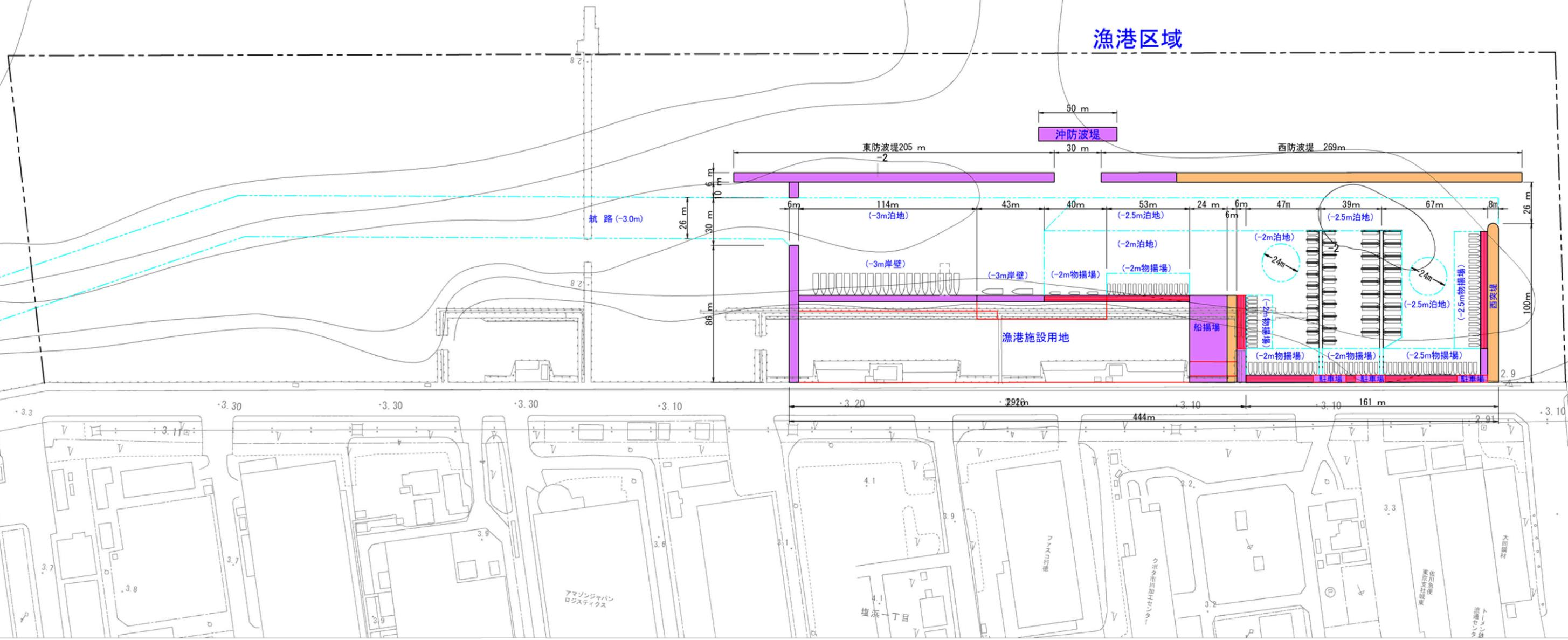
鋼管杭 配置図 S=1/200
