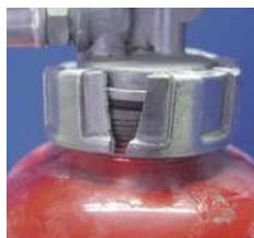
× キャップの破損
