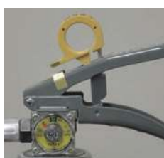
× 安全栓の抜けかけ
