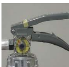
× 安全栓の脱落
