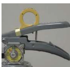
× レバー支えの脱落
