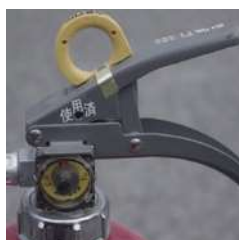
× 表示装置の脱落
