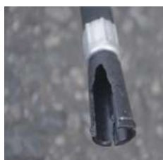
× ノズルの破損
