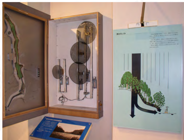
△2枚のパネルの左側は、中の機械が見えている状態。パネルの透明な部分の裏側に帯状の偏光板が張ってある。裏から回転する偏光板を通して光を当てると、一方向に水が動いているように見える。
