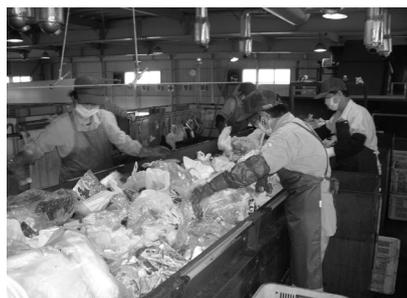
プラスチック製容器包装類の選別作業
