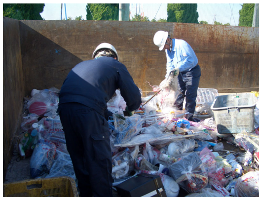
破碎不適物除去作業の様子
