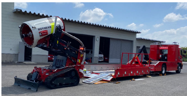
【排煙車 出典:豊田市消防本部】
