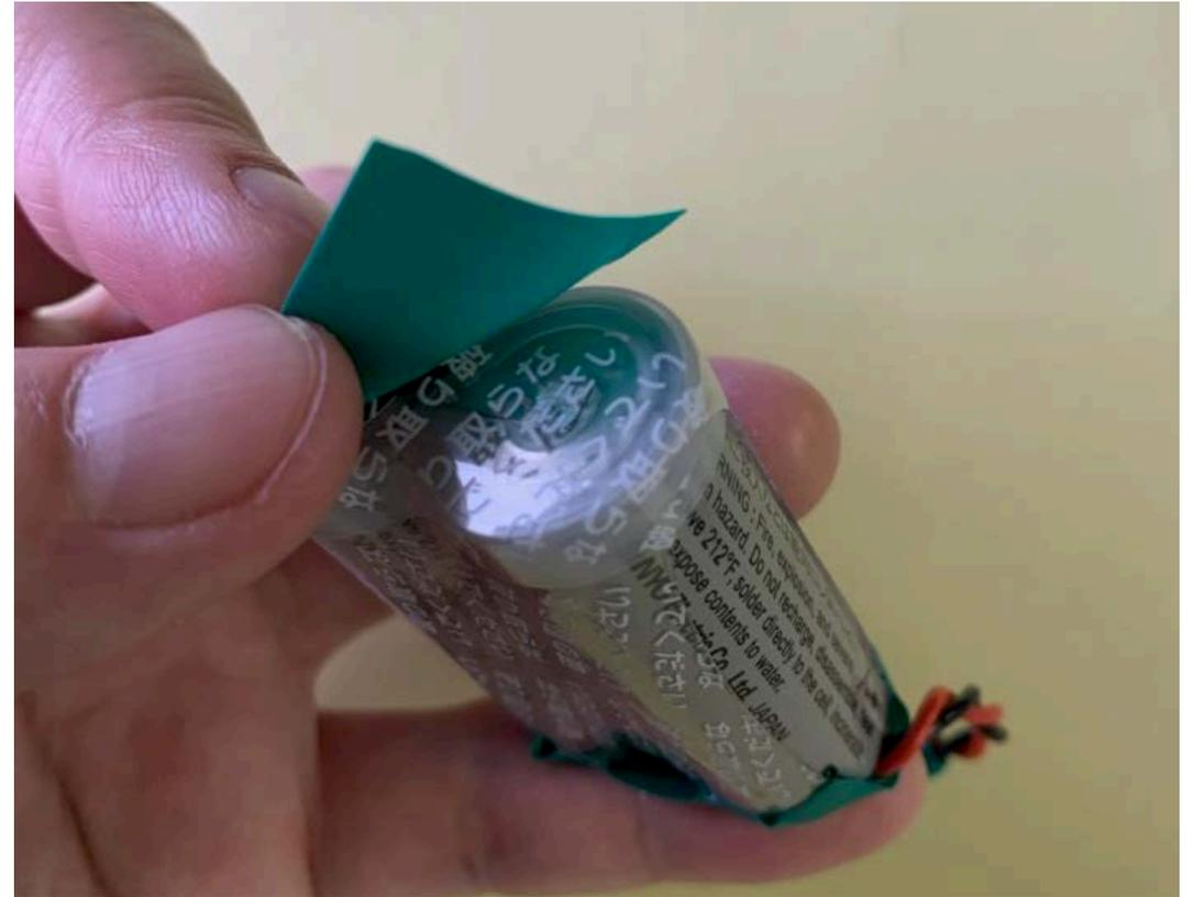
このように電池の接点となる部分をテープで覆えば絶縁処理の完成です。
