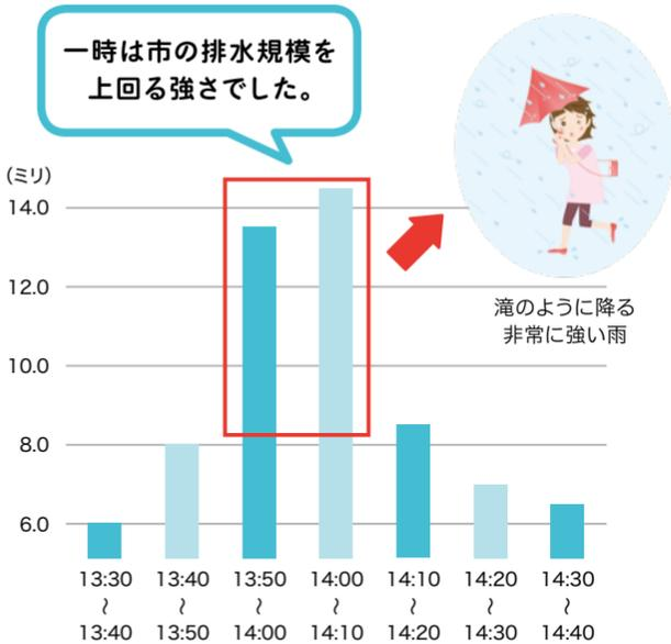
令和3年3月13日の豪雨は活発な雨雲が突発的に発生し、市の排水規模（1時間当たり50ミリ）を一時上回り、道路の側溝や水路などで排水能力が追い付かず、市内各地で浸水被害が発生しました。
