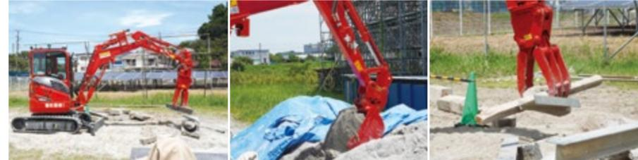
自然災害などに出動する車両です。重機は先端を交換することで、土砂やがれきなどの除去、重量物の撤去など用途に合わせた使用ができます。
