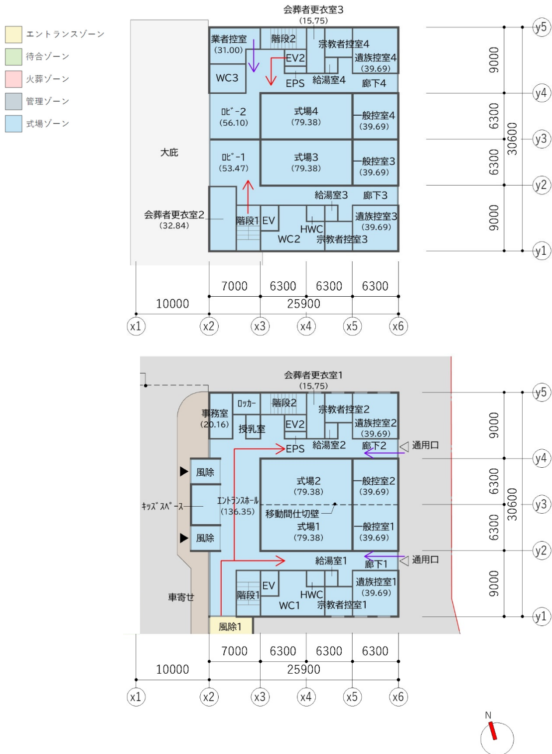
図4-(2)-3 式場棟1・2階平面図(縮尺1:500)
