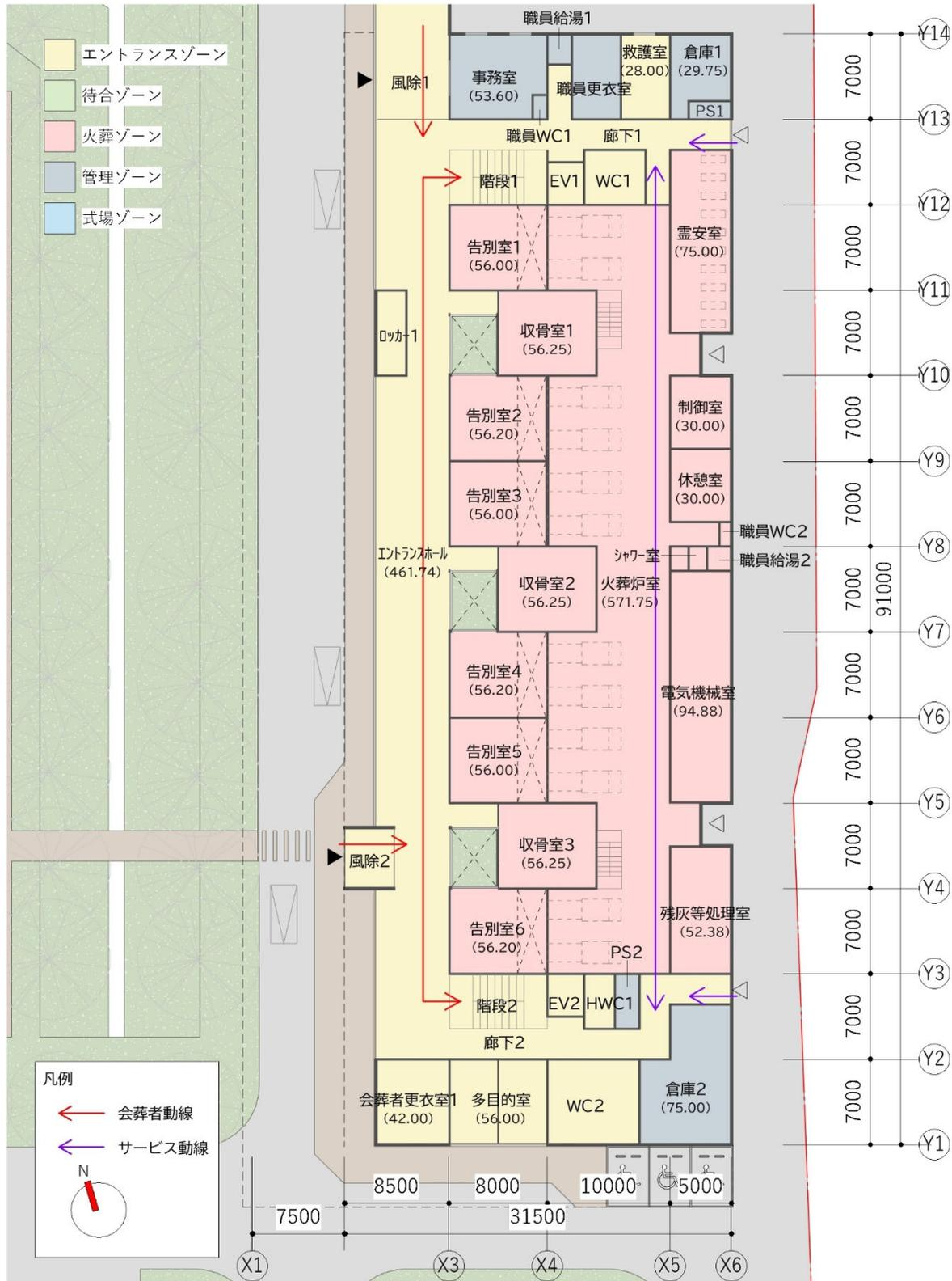
図4-(2)-2 火葬・待合棟2階平面図（縮尺1：500）
