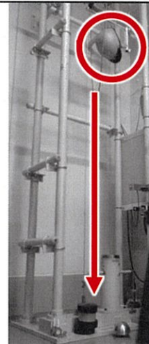
衝撃吸収性試験の様子
